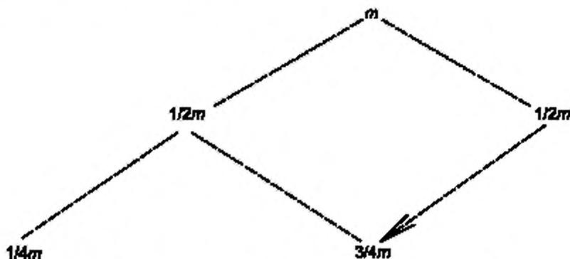
Примечание — Пунктирные линии означают деление пробы на две частичные пробы.
