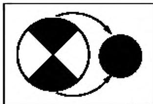
Рисунок А.1 — Схема деления проб методом квартования
