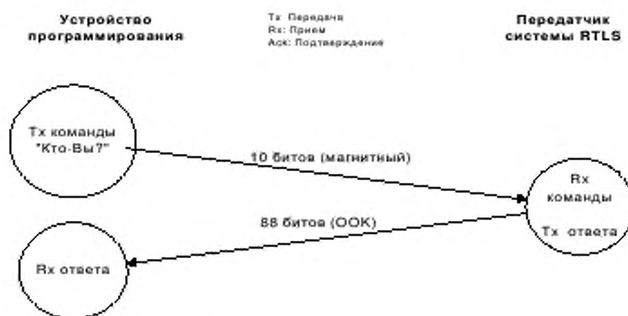
Рисунок 14 — Обмен сообщениями между устройством программирования и передатчиком системы RTLS для передачи команды "Кто вы?"
