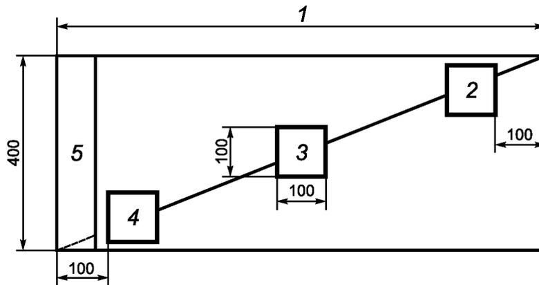
1 — ширина полотна материала; 2, 3, 4 — образцы; 5 — кромка
