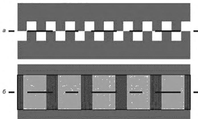
а — для горизонтальной разметки в виде сплошной одиночной полосы (наносимой поперек оси автомобильной дороги), б — для горизонтальной разметки в виде полосы из квадратов (расположенных в шахматном порядке), в виде сплошных полос (расположенных поперек оси искусственной неровности)
