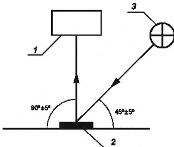
1 — спектрофотометр или колориметр для измерения координат цветности, спектрофотометр, колориметр или яркомер для измерения коэффициента яркости; 2 — дорожная разметка; 3 — источник света
