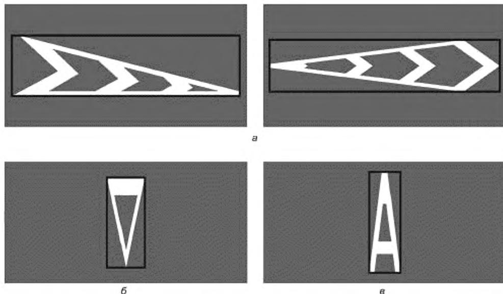
● — для горизонтальной разметки в виде наклонных полос (включая ломаные), ограниченных сплошными одиночными линиями; б — для горизонтальной разметки в виде равнобедренного треугольника, обращенного вершиной к водителю, не окрашенного внутри; в — для горизонтальной разметки в виде изображения буквы «А»
