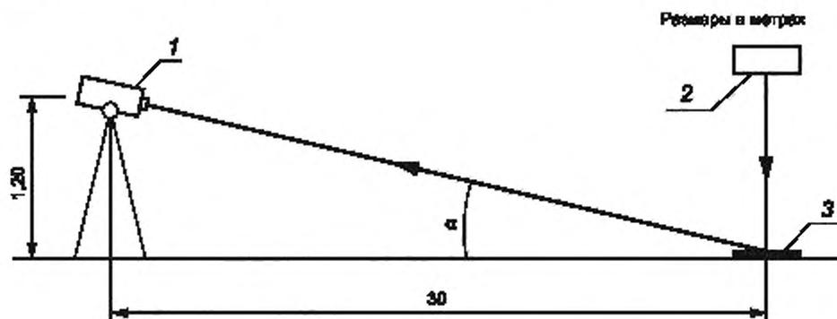
1 — фотоприемник, 2 — источник света типа  $D_{65}$  по ГОСТ 7721; 3 — поверхность разметки
