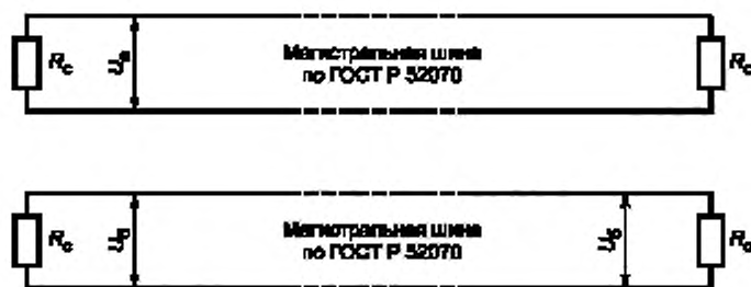
Рисунок 6 — Измерение взаимного влияния магистральных шин
