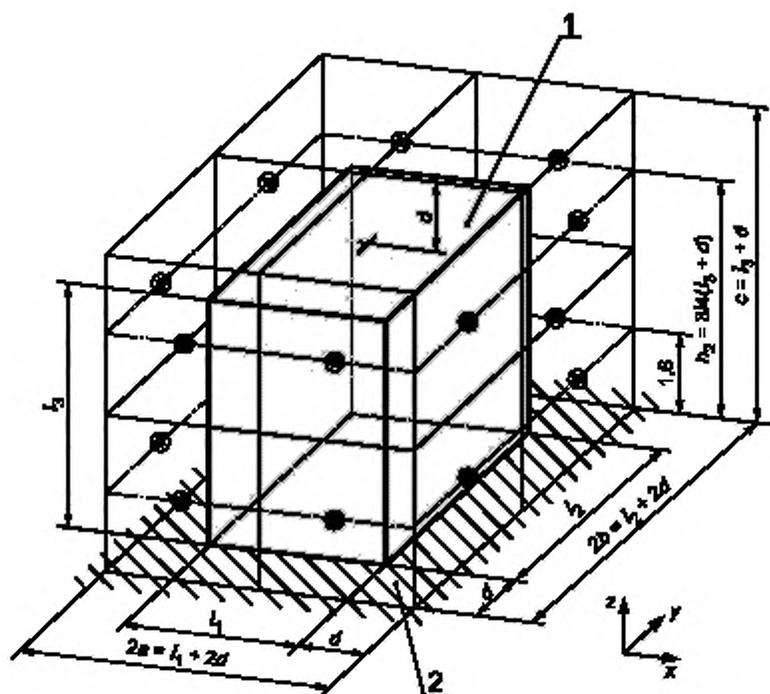
1 — огибающий параллелепипед ( $l_1, l_2, l_3$  — размеры огибающего параллелепипеда); 2 — звукоотражающая поверхность;
