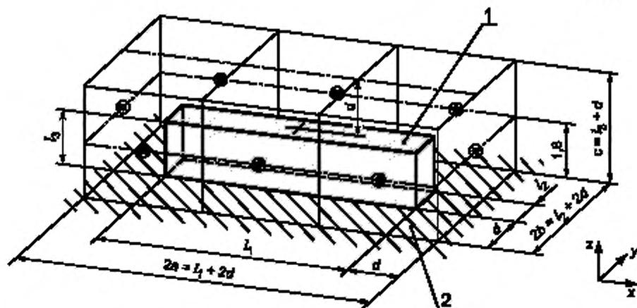
1 — огибающий параллелепипед ( $l_1, l_2, l_3$  — размеры огибающего параллелепипеда); 2 — звукоотражающая поверхность;  $2a, 2b, c$  — размеры измерительной поверхности;  $d$  — измерительное расстояние по 3.2.3
