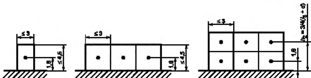
В общем случае  $d = 1$  м [если  $d = 0,5$  м (ИСО 3746)],  $d$  — измерительное расстояние по 3.23,  $h_2$  — по 12.2.2.2
