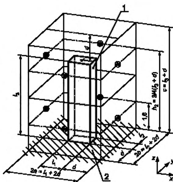
1 — огибающий параллелепипед ( $l_1, l_2, l_3$  — размеры огибающего параллелепипеда); 2 — звукоотражающая поверхность;  $2a, 2b, c$  — размеры измерительной поверхности;  $d$  — измерительное расстояние по 3.2.3,  $h_2$  — по 12.2.2.2
