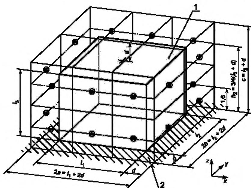
1 — огибающий параллелепипед ( $l_1, l_2, l_3$  — размеры огибающего параллелепипеда); 2 — звукоотражающая поверхность.
