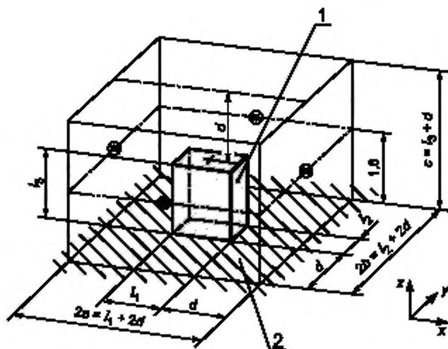
1 — огибающий параллелепипед ( $l_1, l_2, l_3$  — размеры огибающего параллелепипеда); 2 — звукоотражающая поверхность;
