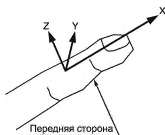
Рисунок 3 — Стандартное положение и система координат пальца. Правосторонняя система координат
