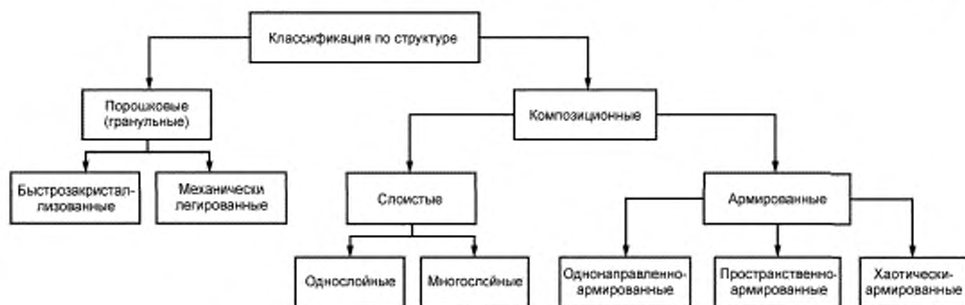
Рисунок 1 — Классификация порошковых материалов по структуре
