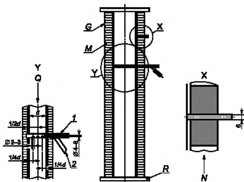
*G* — измерительный участок; *M* — теплоизоляция, *N* — точки измерения тяги; *Q* — точки измерения состава дымовых газов и температуры; *R* — фланец, 1 — вход для измерительного датчика; 2 — выход для продуктов сгорания
