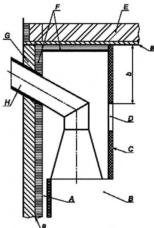
*A* — конвекционный воздух; *B* — отопительный аппарат; *C* — кожух; *D* — воздухораспределительная решетка; *E* — потолок; *F* — изоляция; *G* — стенка испытательного угла, *H* — соединение с измерительным участком; *a* — точки измерения температуры; *b* — расстояние до горючих конструкций согласно указаниям изготовителя
