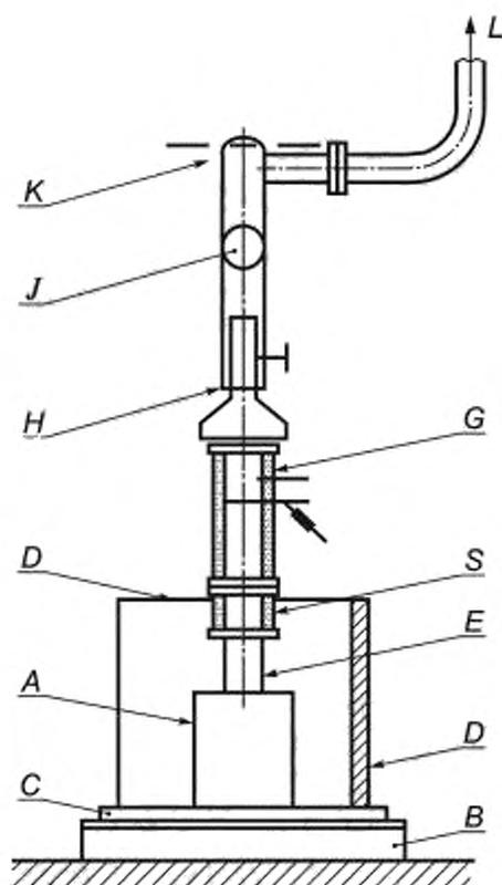
*A* — отопительный прибор; *B* — платформенные весы контроля выгорания топлива; *C* — пол испытательного угла, *D* — боковая стенка испытательного угла; *E* — дымоход; *G* — измерительный участок; *H* — регулируемая часть трубы; *J* — регулируемая дроссельная заслонка; *K* — вентилятор; *L* — выпуск в атмосферу; *S* — переходник для дымовых газов (прямой)
