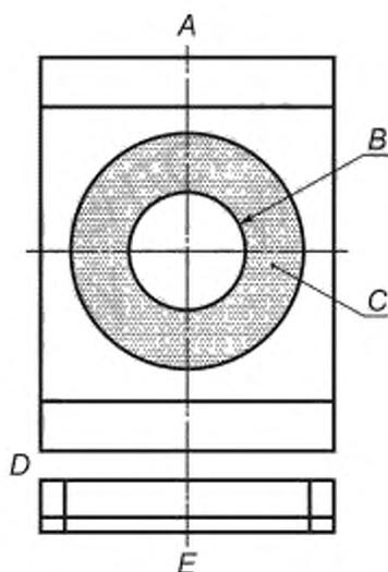
A — вид спереди; B — дымоход; C — теплоизоляция, расстояние  $(150 \pm 5)$  мм до дымохода, заполненное изоляционным материалом; D — аналогично конструкции на рисунке А.3; E — вид сверху
