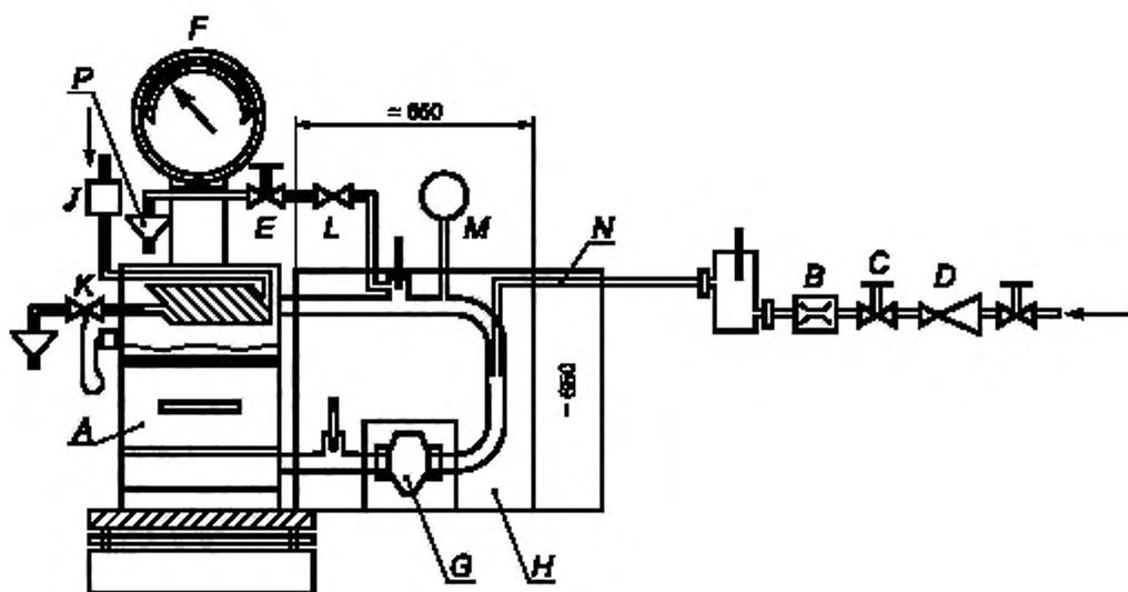
*A* — котел с водяным контуром; *B* — устройство для измерения объемного расхода; *C* — дроссельная заслонка; *D* — редукционный клапан; *E* — запорный клапан; *F* — шкала платформенных весов контроля выгорания топлива; *G* — циркуляционный насос; *H* — стальной ящик, изолированный 120 мм слоем минеральной ваты или заполненный кусочками пробки; *J* — предохранительное устройство
