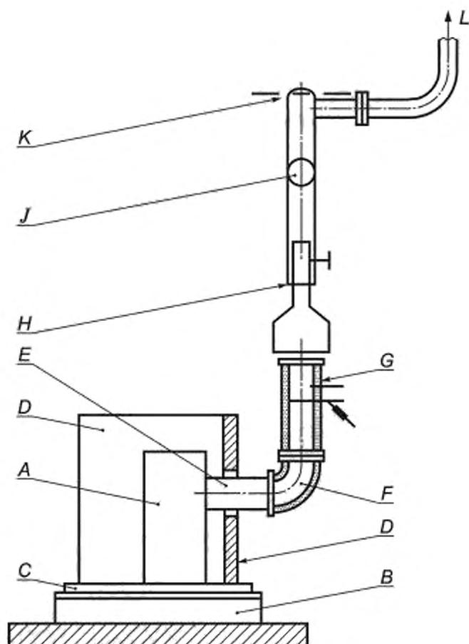
*A* — отопительный прибор; *B* — платформенные весы контроля выгорания топлива; *C* — пол испытательного угла; *D* — боковая стенка испытательного угла; *E* — дымоход; *F* — переходник для дымовых газов (колени); *G* — измерительный участок; *H* — регулируемая часть трубы; *J* — регулируемая дроссельная заслонка; *K* — вентилятор; *L* — выпуск в атмосферу
