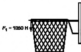
Рисунок Б.1 — Схема приложения нагрузки при испытании кольца с амортизатором одной нагрузкой
