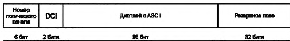
Рисунок 20 — Структура сообщения дисплею при данных дисплею ASCII
