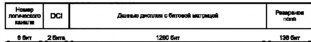
Рисунок 21 — Структура сообщения дисплею при данных дисплею с битовой матрицей
