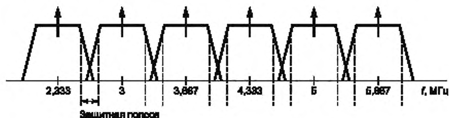
Рисунок 3 — Распределение полосы при шести модулированных поднесущих
