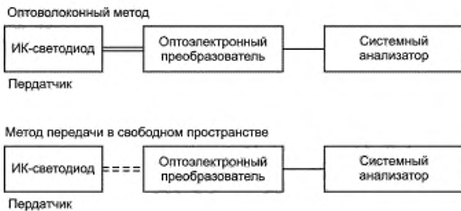
Рисунок 32 — Система измерения паразитного излучения
