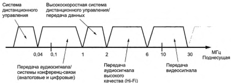
Рисунок 2 — Распределение полосы согласно МЭК 61603
