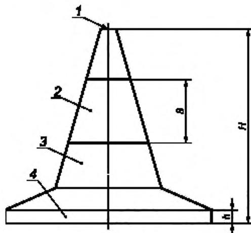
$H$  — высота конуса,  $h$  — толщина внешнего края опорной плиты,  $S$  — ширина световозвращающей поверхности полосы белого цвета 1 — вершина тела дорожного конуса, 2 — световозвращающая поверхность, 3 — тело дорожного конуса, 4 — опорная плита дорожного конуса
