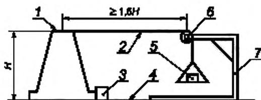
*H* — высота временного дорожного барьера, временного дорожного щита, дорожного конуса, дорожной пластины, дорожной сигнальной вежи, 1 — временный дорожный барьер, временный дорожный щит, дорожный конус, дорожная пластина, дорожная сигнальная вежа; 2 — шнур; 3 — упор; 4 — ровная горизонтальная поверхность; 5 — груз; 6 — блок; 7 — штатив
