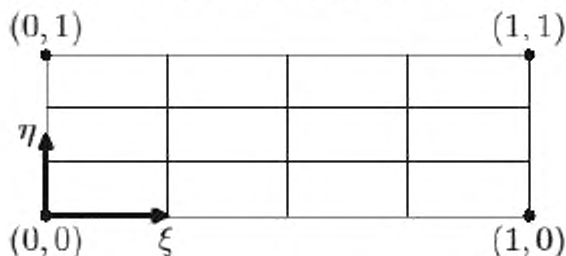
Рисунок 12 — Параметрическая система координат для двумерной структурированной сетки
