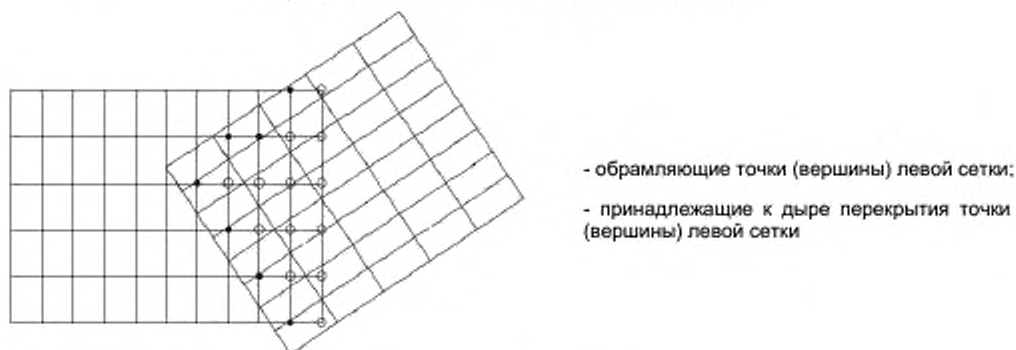
Рисунок 23 — Стык с перекрытием
