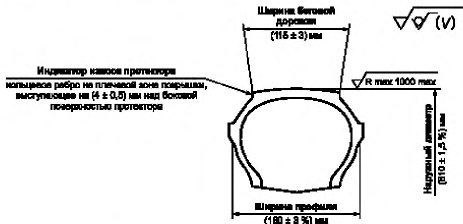
Рисунок А.1 — Размеры шины ИКС в накачанном состоянии
