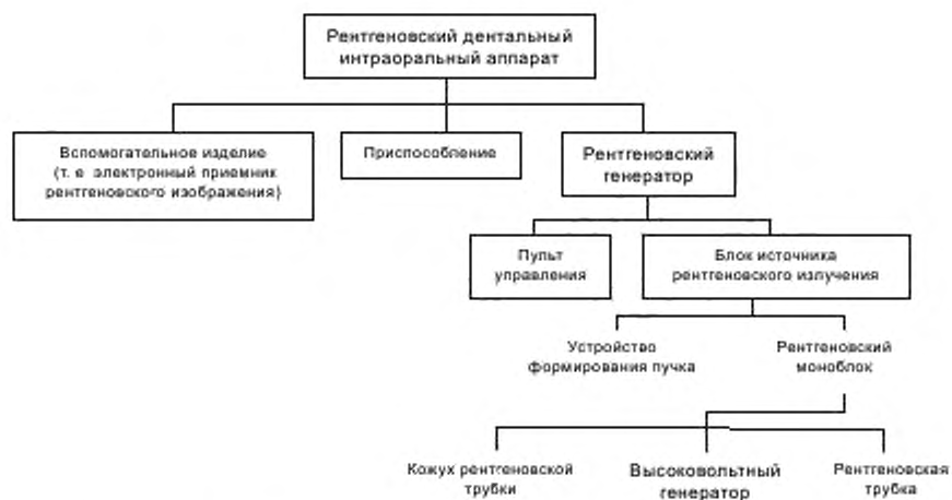
Рисунок ВВ.1 — Структура РЕНТГЕНОВСКОГО ДЕНТАЛЬНОГО ИНТРАОРАЛЬНОГО АППАРАТА
