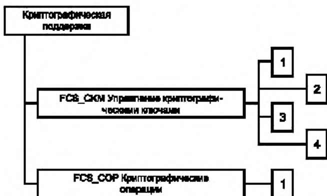
Рисунок 5.1 — Декомпозиция класса «Криптографическая поддержка»
