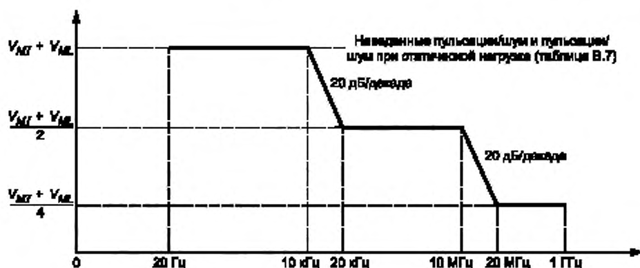
Рисунок В.44 — Пределы пульсаций/шума наведенной помехи и помехи при статической нагрузке базового блока
