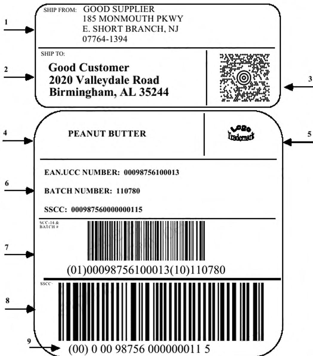
1 — отправитель; 2 — получатель; 3 — двумерный символ для сортировки/прослеживания груза перевозчиком; 4 — описание продукции; 5 — логотип; 6 — расшифровка в виде текста для чтения; 7 — номер EAN.UCC и номер партии; 8 — уникальный идентификатор транспортируемой единицы в символическом UCC/EAN-128; 9 — визуальное представление знаков
