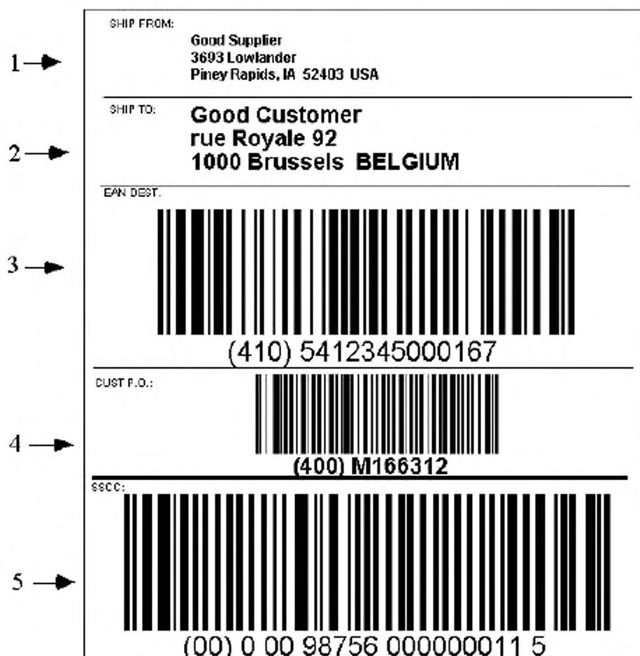
1 — отправитель; 2 — получатель; 3 — ссылка к базе данных перевозчика; 4 — ссылка к базе данных получателя или заказчика; 5 — уникальный идентификатор транспортируемой единицы в символе UCC/EAN-128
