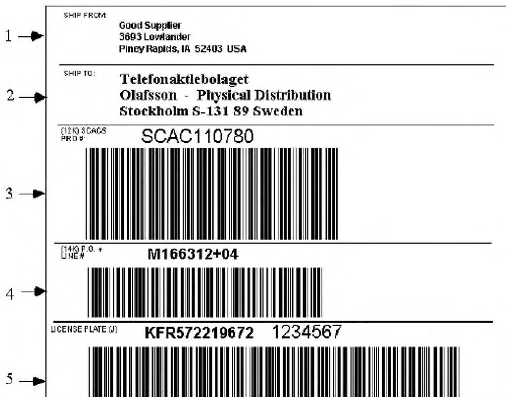
1 — отправитель; 2 — получатель; 3 — ссылка к базе данных перевозчика; 4 — ссылка к базе данных грузополучателя или заказчика; 5 — уникальный идентификатор транспортируемой единицы в символике Code 39 с идентификатором данных J
