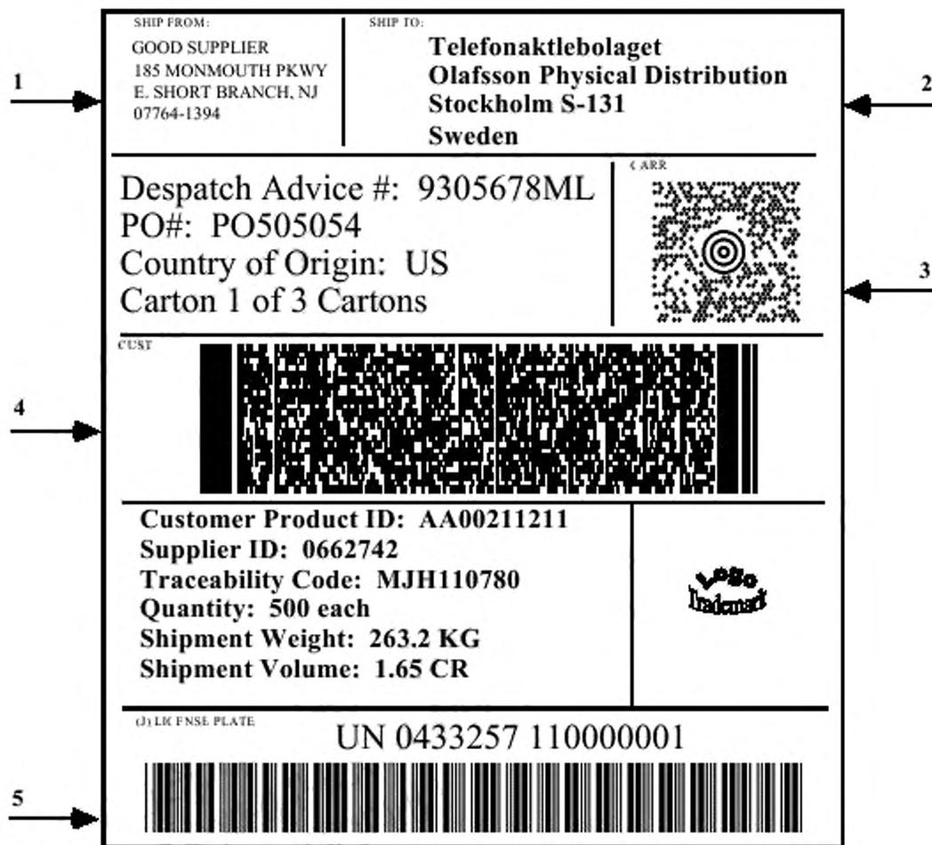
1 — отправитель; 2 — получатель; 3 — двумерный символ для сортировки/отслеживания груза перевозчиком; 4 — двумерный символ с данными получателя или заказчика; 5 — уникальный идентификатор транспортируемой единицы в символе Code 39 с идентификатором данных J
