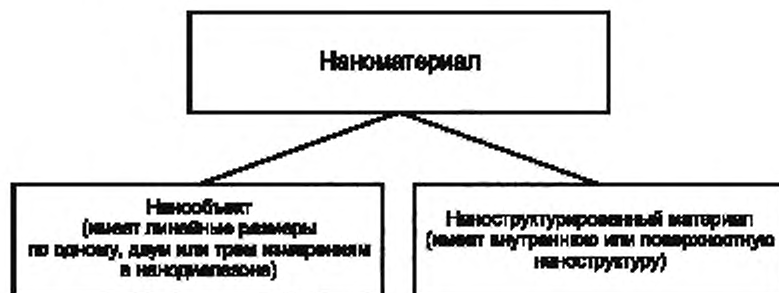
Рисунок 1 — Пример иерархической взаимосвязи определений терминов «наноматериал», «нанообъект» и «наноструктурированный материал»
