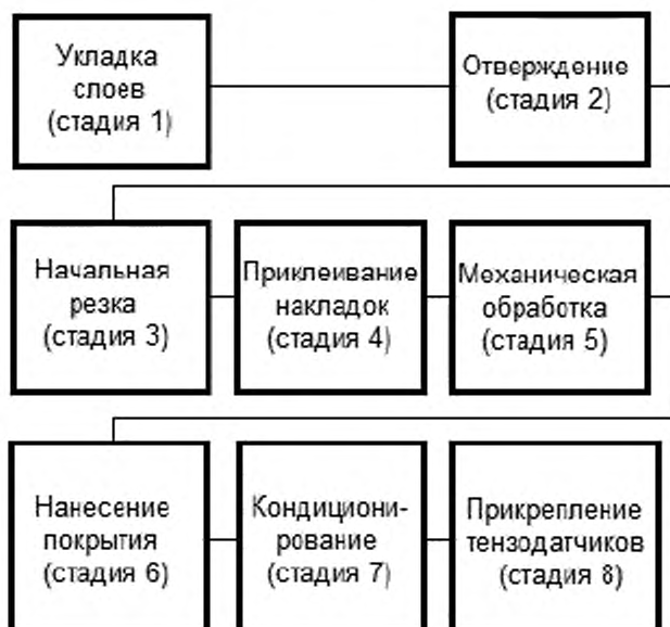
Рисунок 1 — Процесс изготовления образцов для испытания
