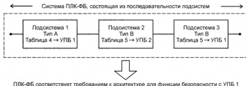
Рисунок 7 — Пример определения максимального значения УПБ для заданной архитектуры
