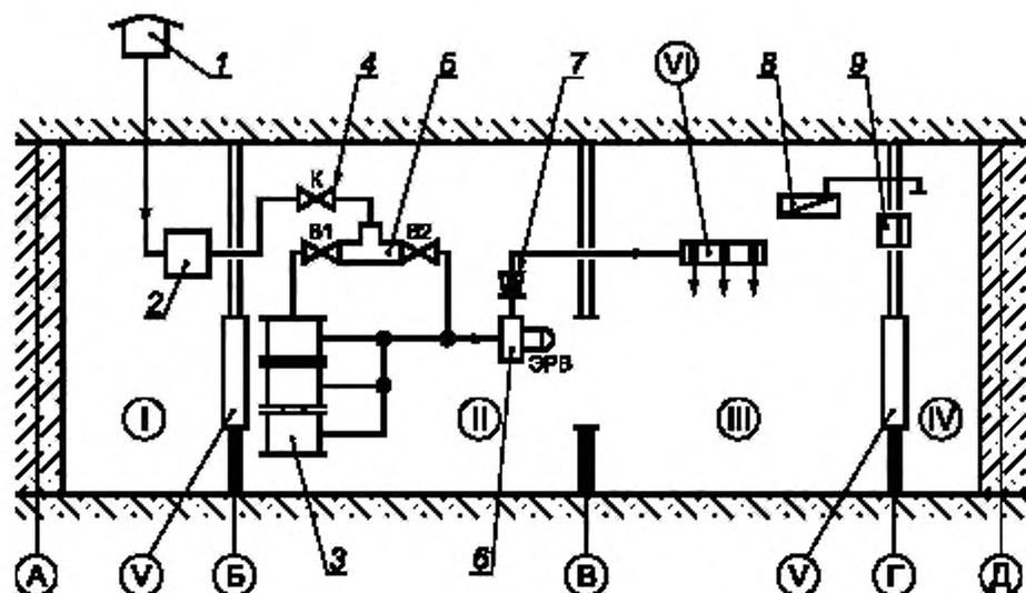
I — венткамера; II — помещение ФВУ; III — помещение для укрываемых; IV — тамбур, V — герметичная дверь;
