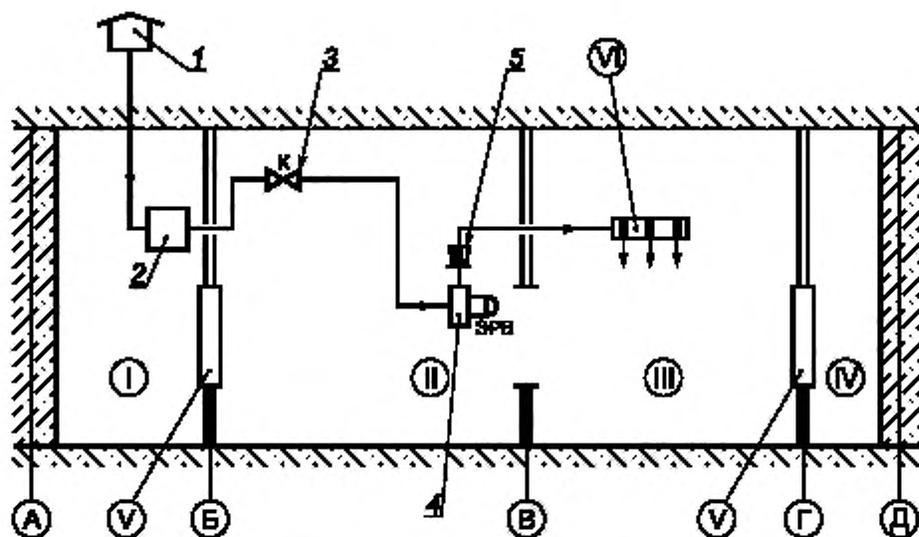
I – венткамера; II – помещение ВУ; III – помещение для укрываемых; IV – тамбур; V – герметичная дверь;
