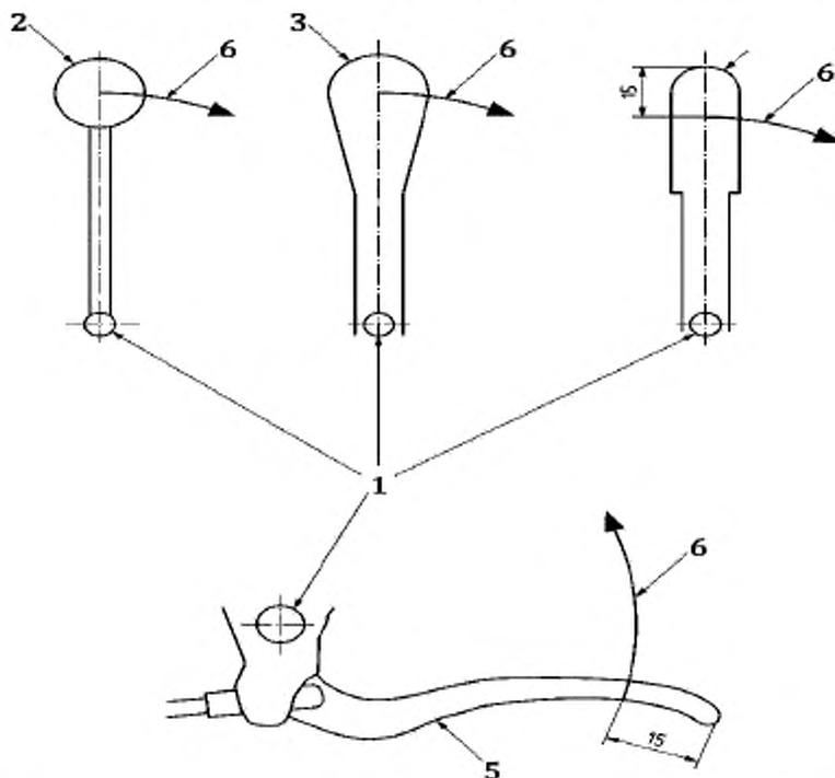
1 — точка поворота рычага; 2 — рычаг со сферической головкой; 3 — конусообразный рычаг;
