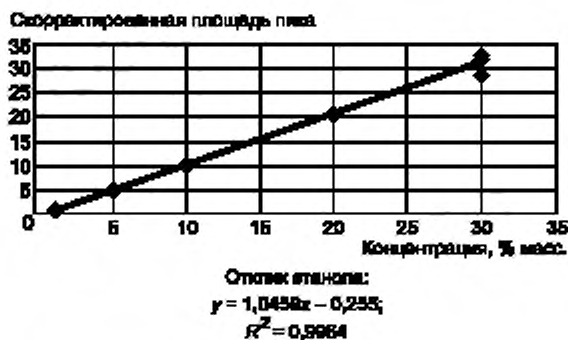
Рисунок А2.2 — Определение расчетного отклика при анализе этанола методом ИА
