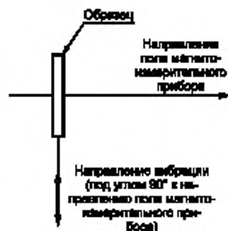
Рисунок 21 — Положение образца при измерении петли гистерезиса в перпендикулярном направлении
