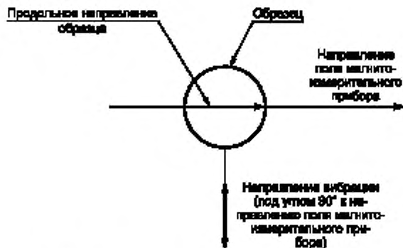
Рисунок 19 — Положение образца при измерении петли гистерезиса в продольном направлении
