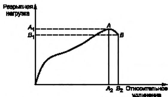
Рисунок 1 — Типичная кривая разрывная нагрузка — относительное удлинение
