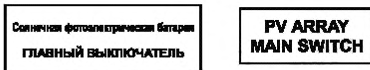
Рисунок F.5 — Пример знака, располагаемого на выключателе — разъединителе ФБ (главном выключателе ФБ), и идентичный знак МЭК
