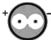
Рисунок 12c — Кабель в стальной оплетке (обычно применяемый только для выходного кабеля ФБ или кабелей фотоэлектрических групп в больших ФБ)
