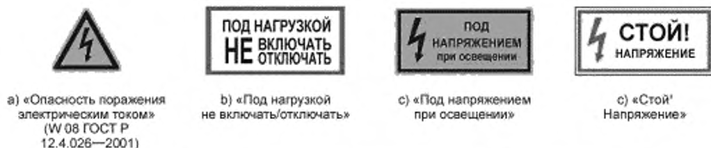
Рисунок F.3 — Примеры знаков, указывающих на то, что любой компонент ФБ может находиться под напряжением в любой момент времени независимо от того, разомкнуты или нет выключатели в ФБ
