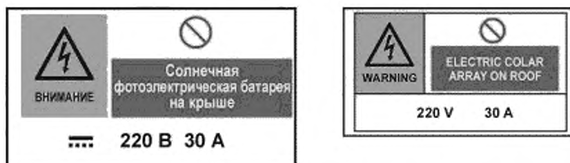
Рисунок F.6 — Пример знака, информирующего об опасности возникновения пожара на главном распределительном щите здания, и идентичный знак МЭК
