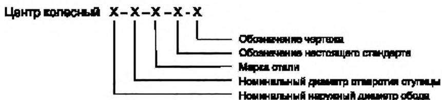
Рисунок 1 — Схема условного обозначения колесных центров
