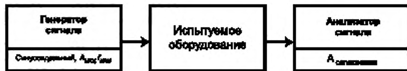
Рисунок 16 — Метод измерения наибольшего паразитного сигнала
