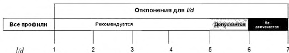
Рисунок 13 — Рекомендации по выбору оптимального соотношения длины пути утечки к межреберному расстоянию
