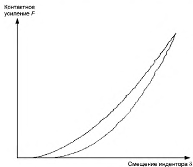
Рисунок 4 — Типовая линейная характеристика зависимости контактной нагрузки от смещения применительно к конфигурации с опорами в неподвижном состоянии
