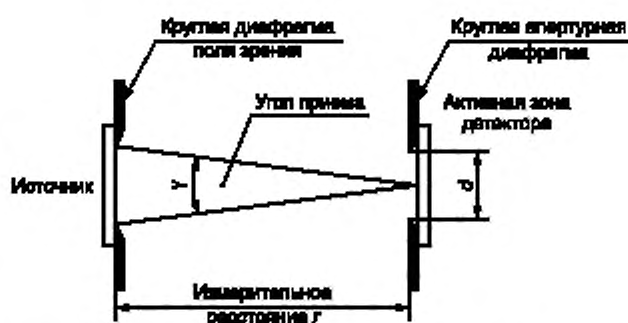
Рисунок 8б — Измерительная установка для доступного источника
