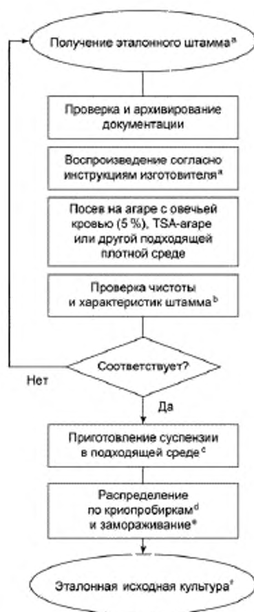
Рисунок В.1 — Блок-схема приготовления контрольной (эталонной) исходной культуры из контрольного (эталонного) штамма
