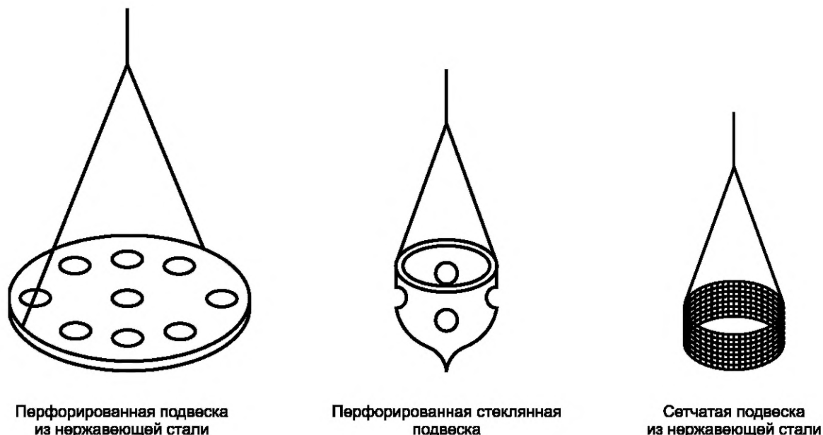
Рисунок 1 — Примеры подставок под испытуемый образец
