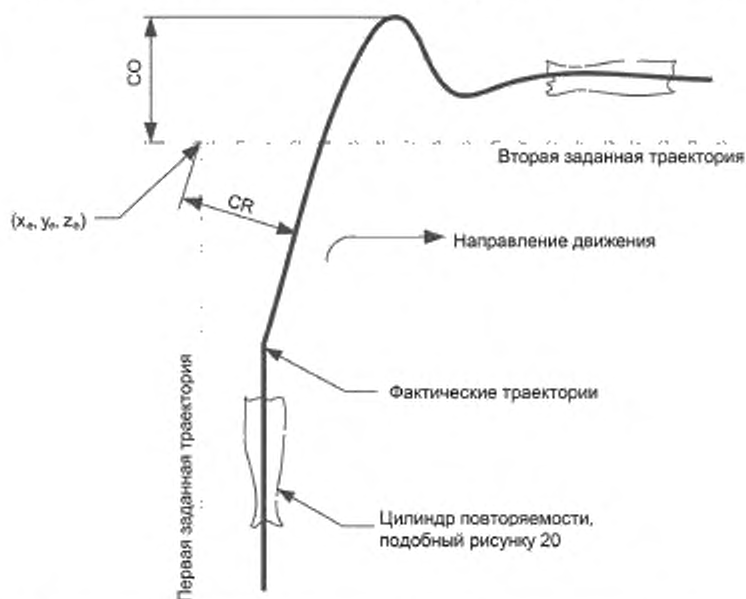
Рисунок 22 — Перерегулирование при повороте и ошибка скругления на повороте для крутого поворота
