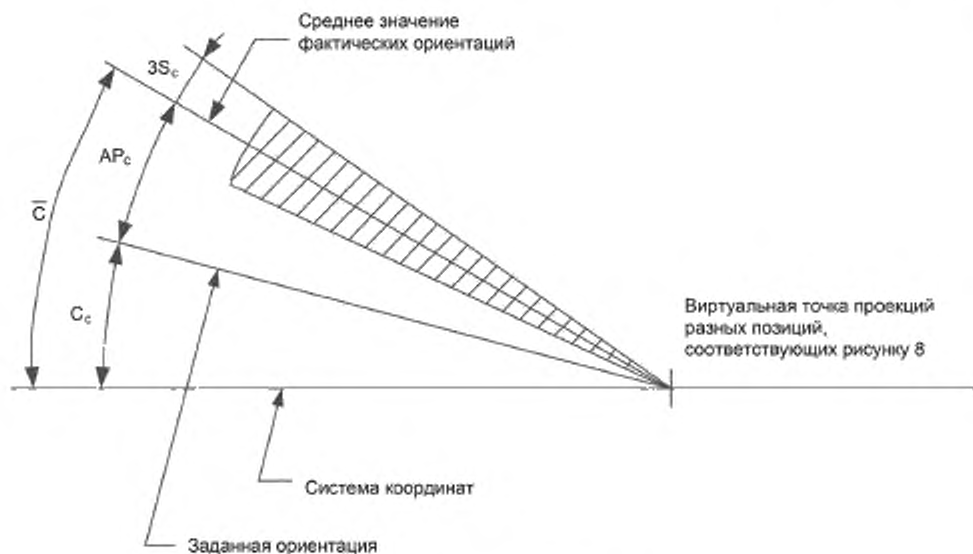
Рисунок 9 — Точность и повторяемость ориентации
