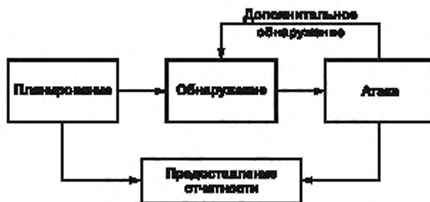
Рисунок 1 — Методика испытаний четырехэтапного проникновения в сеть
