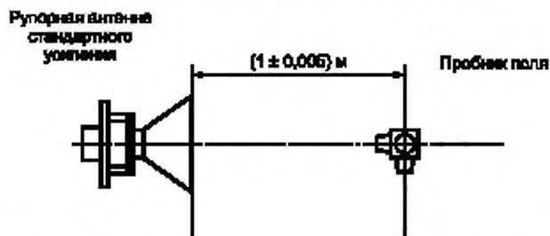
Рисунок 1.10 — Расположение пробника поля при калибровке (вид сверху)
