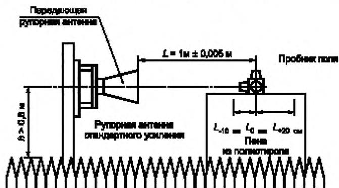
Рисунок I.3 — Испытательная установка для валидации камеры
