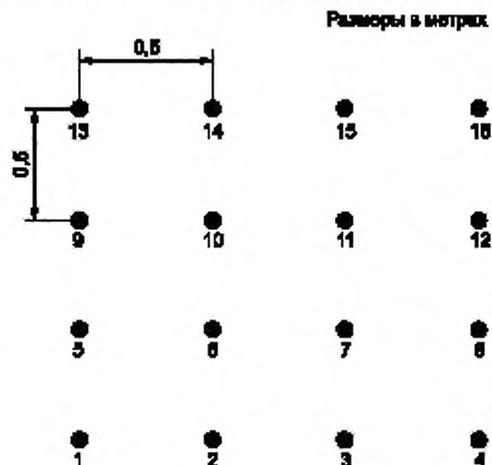
Рисунок D.1 — Положения измерительной антенны (датчика) в плоскости однородного поля
