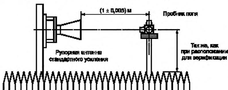
Рисунок 1.9 — Расположение пробника поля при калибровке
