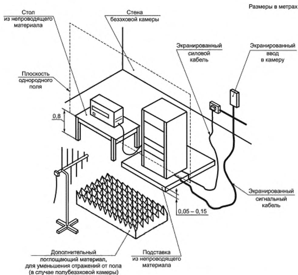
Рисунок 5 — Пример испытательной установки для напольного оборудования
