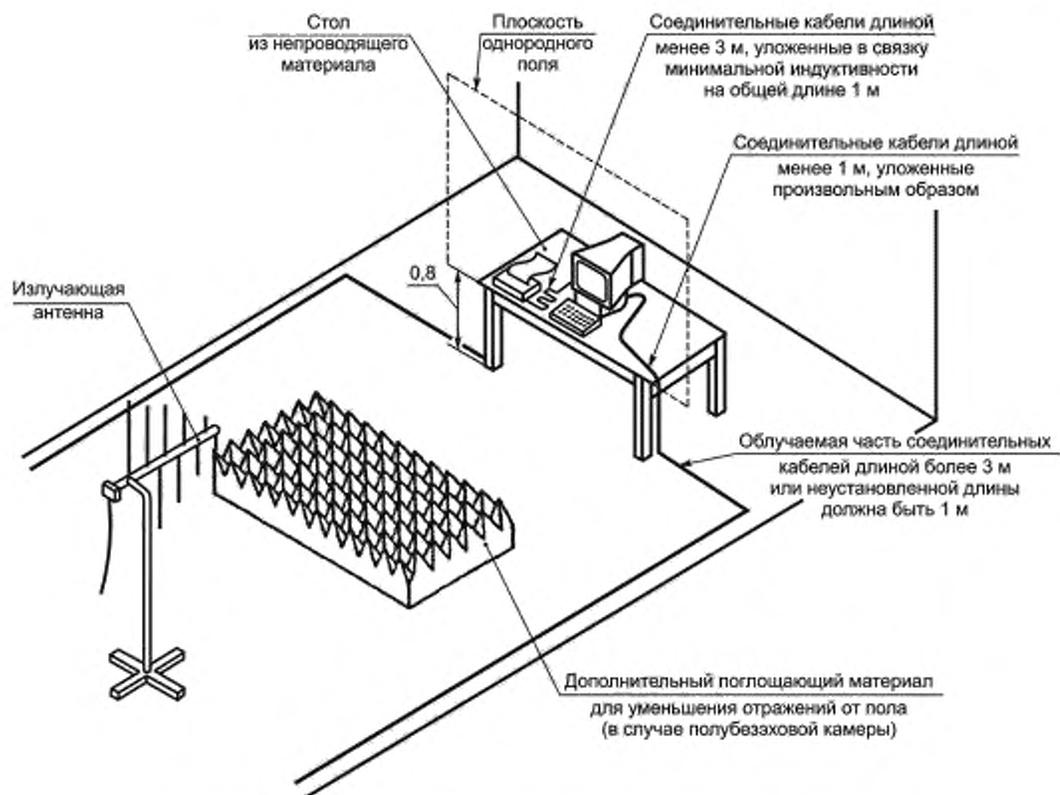
Рисунок 6 — Пример испытательной установки для настольного оборудования
