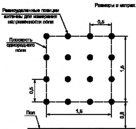
Рисунок 4 — Калибровка поля; размеры плоскости однородного поля
