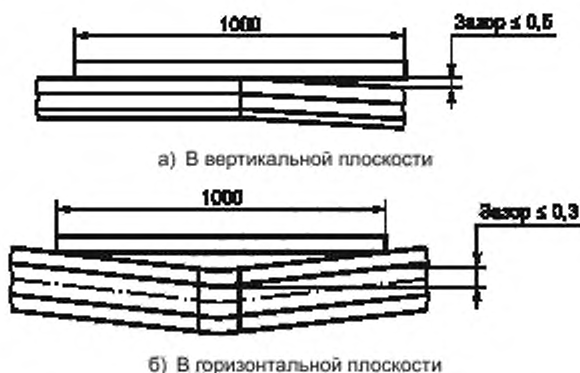
Рисунок 5 — Схема контроля прямолинейности рельсов
