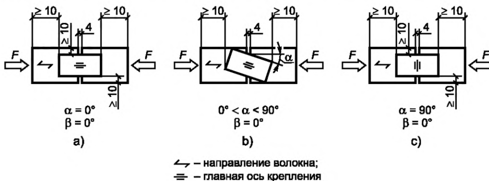
Рисунок 5 — Образец для определения прочности пластин на сжатие
