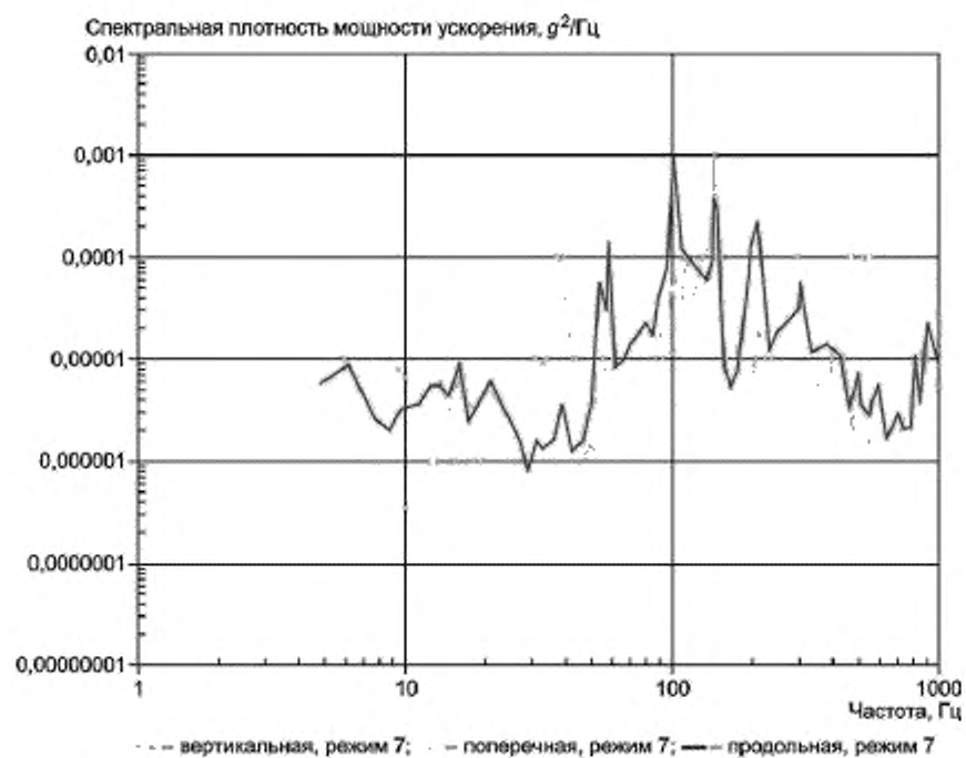
Рисунок 11 — Измерения вибрации на самолете Tristar (датчик в носовой части, крейсерский режим)
