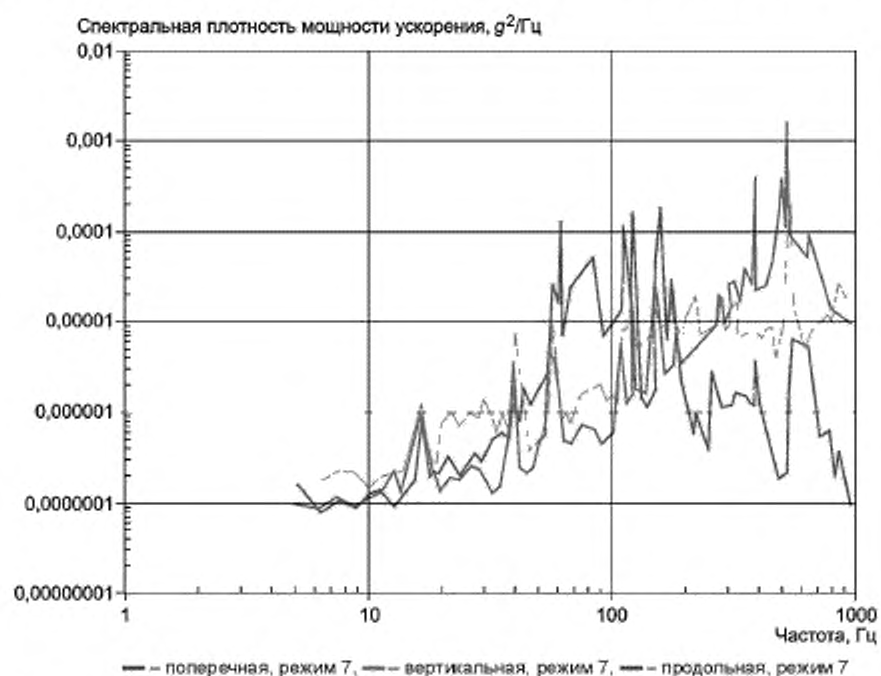
Рисунок 10 — Измерения вибрации на самолете Tristar (датчик в центре тяжести, крейсерский режим)
