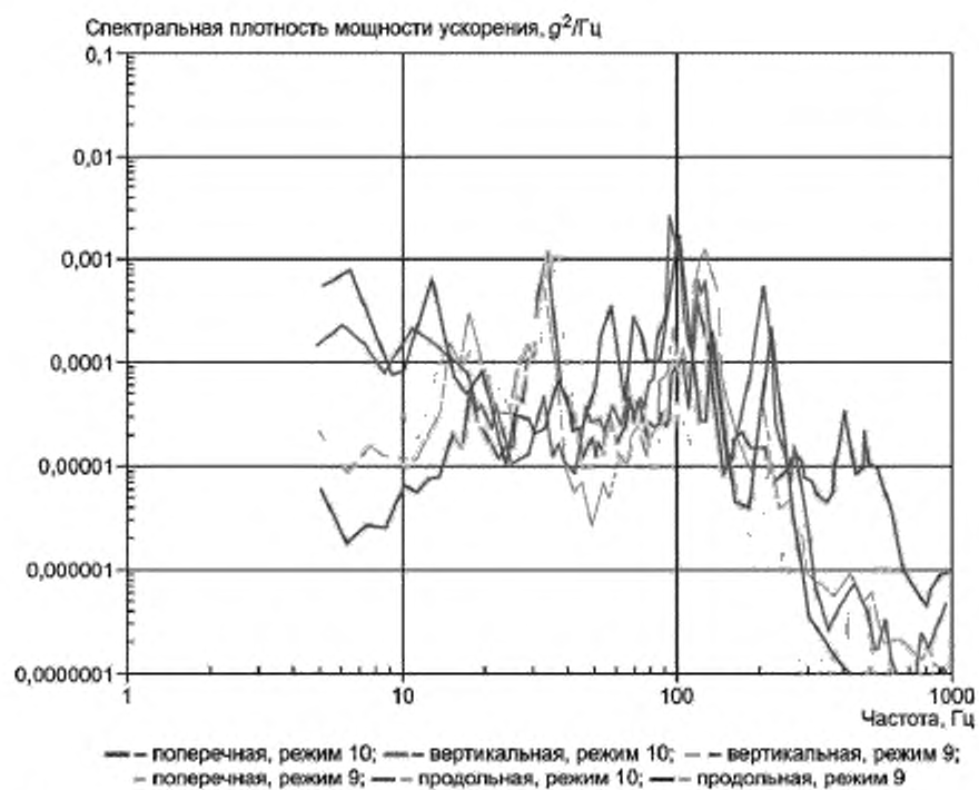
Рисунок 13 — Измерения вибрации на самолете Tristar (датчик в носовой части, посадка)
