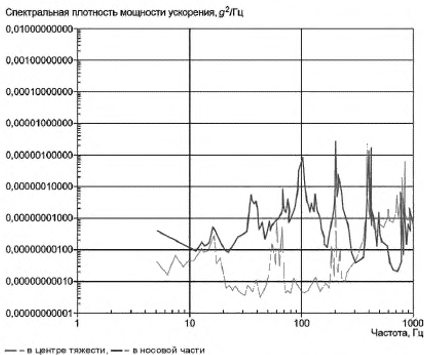
Рисунок 2 — Измерение собственного шума измерительной системы самолета Tristar
