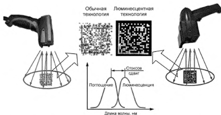
Рисунок ДА.1 — Иглоударное маркирование с применением люминесцентного состава
