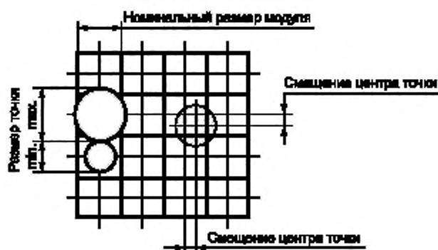
Рисунок Е.1 — Схема определения номинального размера модуля, смещения центра точки и размера точки
