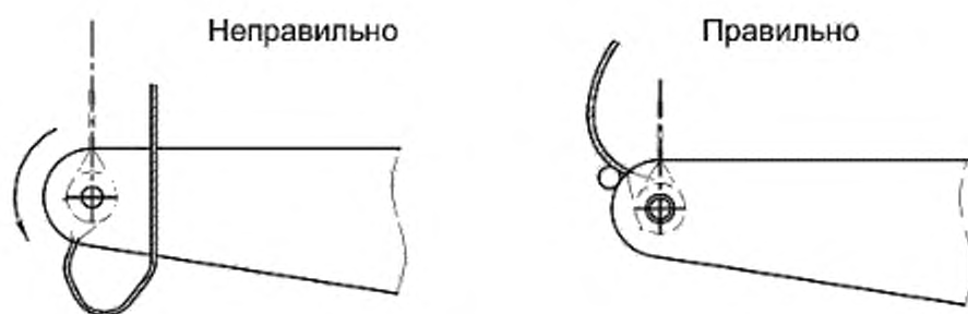
Рисунок 8 – Устройства, исключающие образование петель и перекруток
