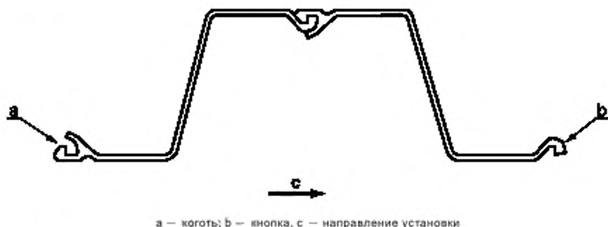
Рисунок 11 — Направление установки для Z-образных шпунтовых свай с замковыми соединениями на когтевых шайбах и кнопочными замковыми соединениями
