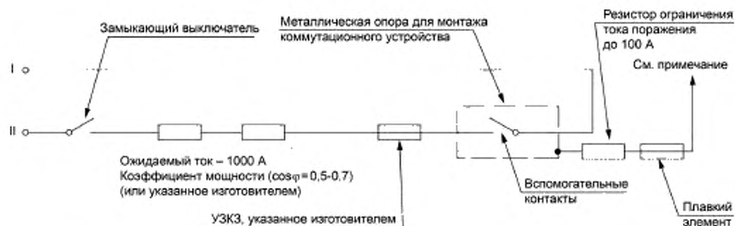
Рисунок 3 — Цель для испытания на условный ток короткого замыкания
