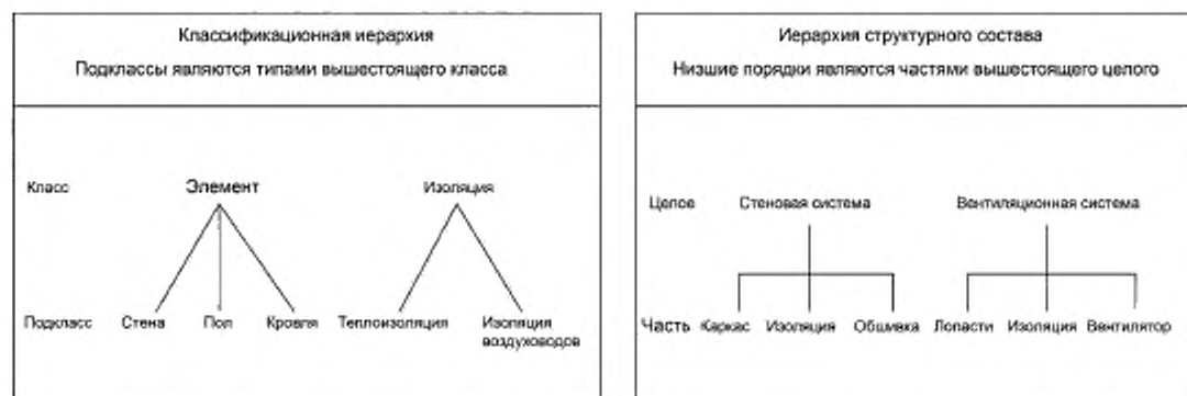
Рисунок 2 — Иерархия классификации и иерархия структурного состава
