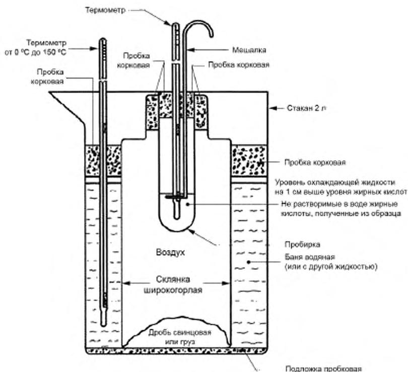
Рисунок 1 — Охлаждающее устройство
