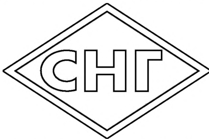
Рисунок 4.4 — Образец опознавательного знака КТС категорий М2 и М3, использующих в качестве топлива сжиженный нефтяной газ (СНГ) или компримированный природный газ (КПГ)
