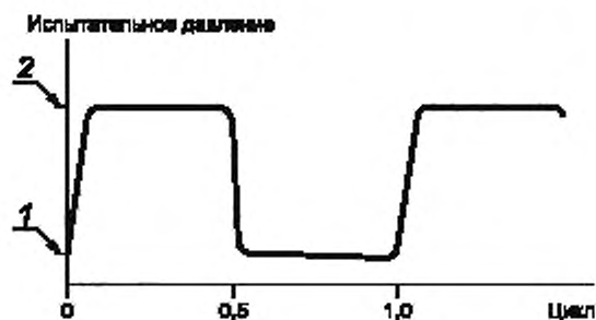
Рисунок F.1 — Цикл импульса давления
