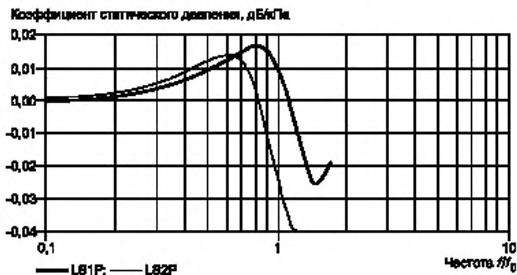
Рисунок Г.1 — Примеры зависимости коэффициентов статического давления для микрофонов типов LS1P и LS2P от относительной частоты f/f_0 .
